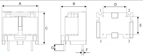
PCB aperture ≥ Ф 1.4mm
