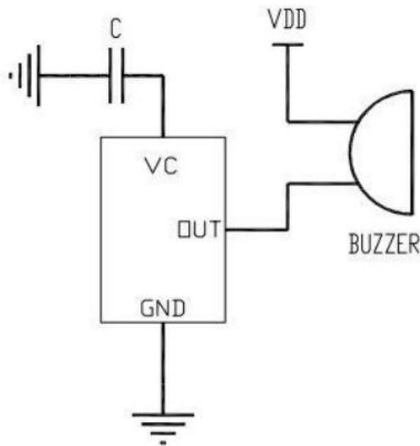
注：\*建议在芯片电源输入端增加 1uF 电源滤波电容。
