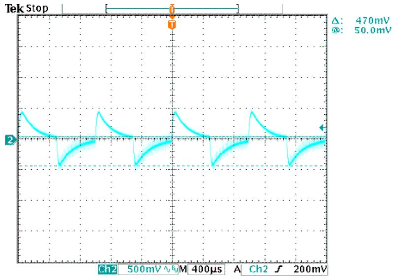
LOAD TRANSIENT WAVE(5V<sub>OUT</sub> 0.2A~1A)
