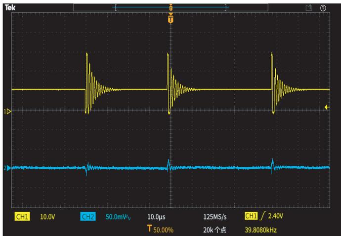
图 7, SW波形 vs. 输出纹波,  $I_{LOAD}=0A$
