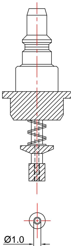
Nozzle Diameter:  $\text{Ø}1.0\text{mm}$ ;
