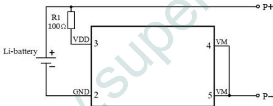
**R1 选择：**R1 太小，起不到滤波和保护内部电路的作用，建议不小于  $100\Omega$ ，同时因为各种检测阈值是对于 DW02KA 电路 VDD 端电压而言，而 VDD 端通过 R1 与电池连接，如果 R1 太大将会导致各检测阈值与电池实际电压偏差增加；因此 R1 不宜太大，应控制在  $1k\Omega$  以内；
