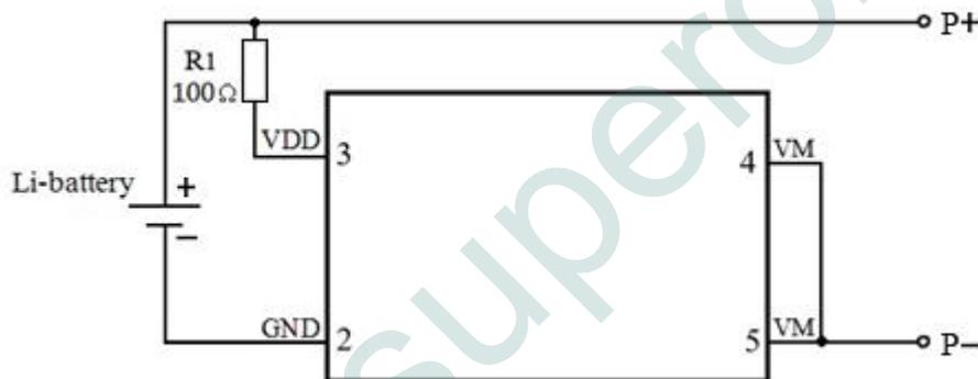
**R1 选择：**R1 太小，起不到滤波和保护内部电路的作用，建议不小于  $100\Omega$ ，同时因为各种检测阈值是对于 DW02RA 电路 VDD 端电压而言，而 VDD 端通过 R1 与电池连接，如果 R1 太大将会导致各检测阈值与电池实际电压偏差增加；因此 R1 不宜太大，应控制在  $1k\Omega$  以内；
