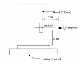
0.5 METER FROM MICROPHONE TO FAN INTAKE
