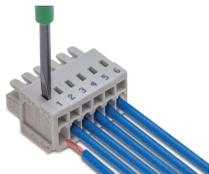
使用 (2.5x0.4) mm 螺丝刀进行接线——笼式弹簧接线单元 (CAGE CLAMP®) 操作方向与进线方向垂直。
