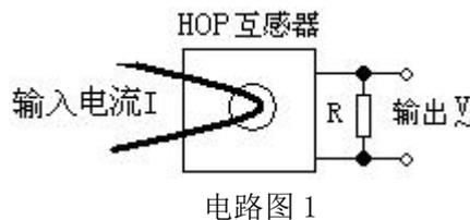
图 2: 负载电阻要求 ≤240Ω, 输出=输出 I\*R。
