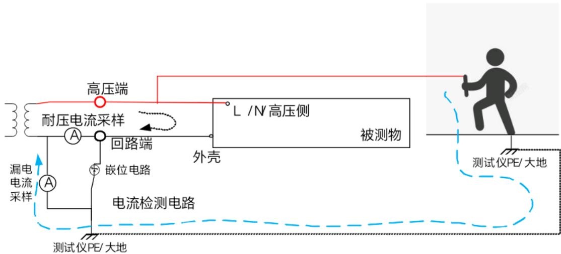
高压测试对操作人员具有一定的危险性，BIN130 系列内置漏电保护机制，当使用人员触电后会在毫秒时间内完成漏电流侦测，立即切断电压输出，保障安全。
