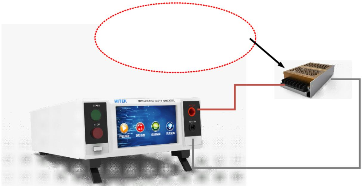
电弧是绝缘材料内部或表面因高压而产生一种自持放电现象，BIN130 系列不仅能够根据电弧等级完成对放电的判定，还能够记录一定频带下的放电波形。
